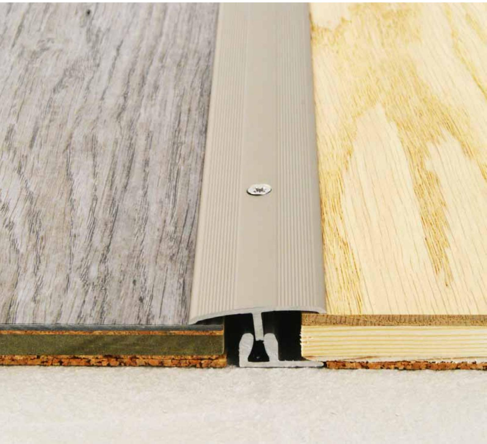
2-teiliges Schraubensystem - vertikal verstellbar, schwenkbar, mit nur einem Grundprofil von 7-16,5 mm - SET inkl. TORX-Schrauben und Dübel
